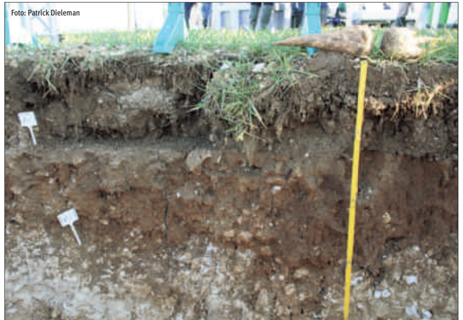
Bij het opstellen van de bodemkaart werden profielputten gemaakt om de structuur van het bodemprofiel te kunnen nagaan.
